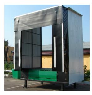
Тамбур перегрузочный предназначен для установки выравнивающей платформы (доклевелера) вне складского помещения и служит в качестве грузового дока, вынесенного за пределы склада. Тамбур в зависимости от исполнения комплектуется герметизатором проёма ГП. Этот комплекс отлично защищает груз от воздействия климатических факторов, а также обеспечивает стабильность температуры в складском помещении. Перегрузочные тамбуры способствуют экономии места на складе, увеличивая его пропускную способность.
